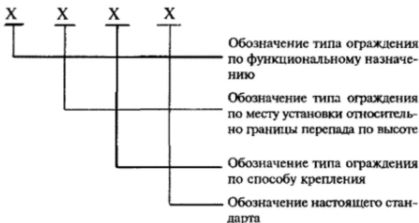
Пример условного обозначения ограждения защитного наружного опорного:
