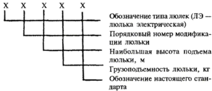
Пример условного обозначения люльки электрической третьей модификации с наибольшей высотой подъема 150 м и грузоподъемностью 200 кг:
